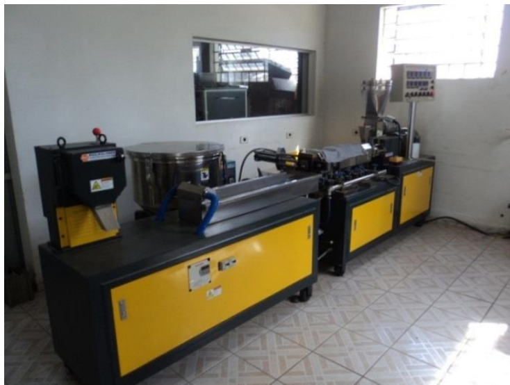
Figura 15 – Extrusora dupla rosca utilizada para processar as formulações de compósitos com fibras de coco e sisal.
