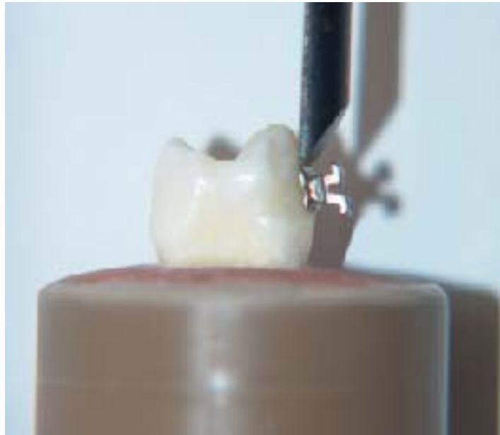
Figura 24 - Cinzel posicionado na interface dente-braquete
