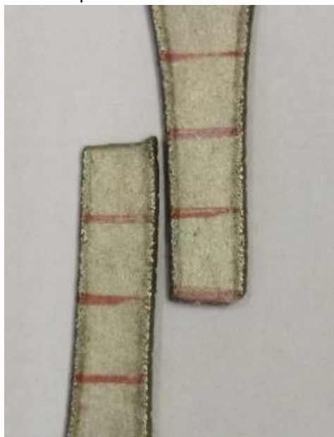
Figura 35 – Região de análise dos cps ensaiados após tração para anisotropia.
