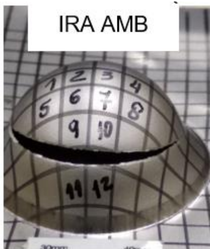
Figura 60 – Medidas das células para cálculo das deformações verdadeiras do IRA AMB.
