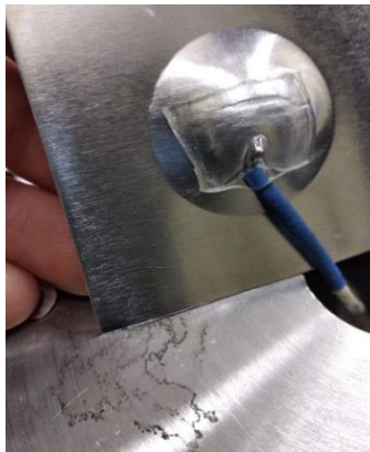
Figura 22 – Fixação do termopar para acompanhamento de temperatura durante o ensaio.
