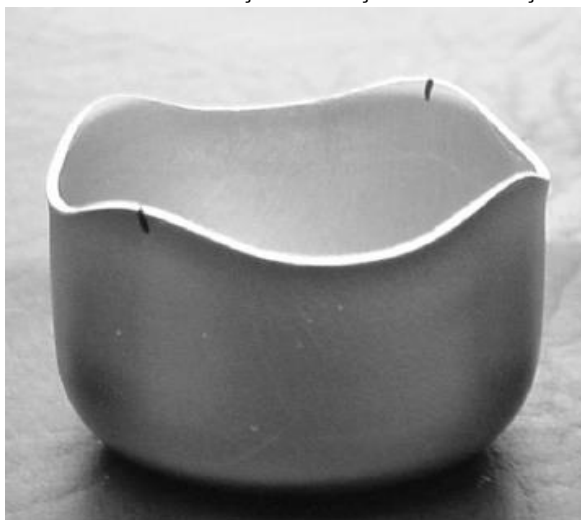
Figura 8 – Aparência típica de um copo deformado profundamente com orelhas abaixo de 0° e 90° em relação à direção de laminação.
