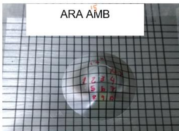
Figura 52 – Medidas das células para cálculo da deformações verdadeiras do ARA AMB.
