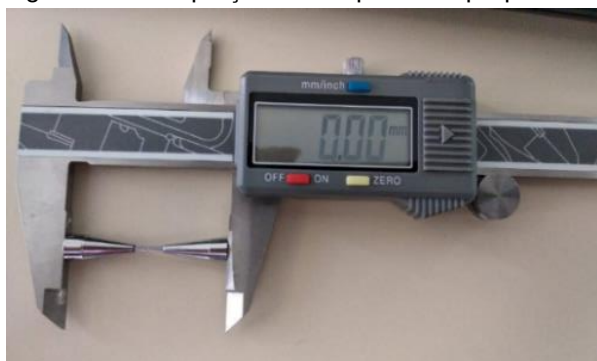
Figura 27 – Adaptação nas esperas do paquímetro.
