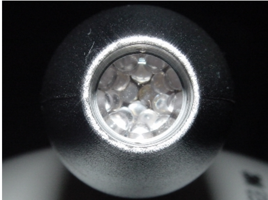
Figura 8 - Vista frontal do aparelho à base de LEDs mostrando a disposição dos 19 LEDs
