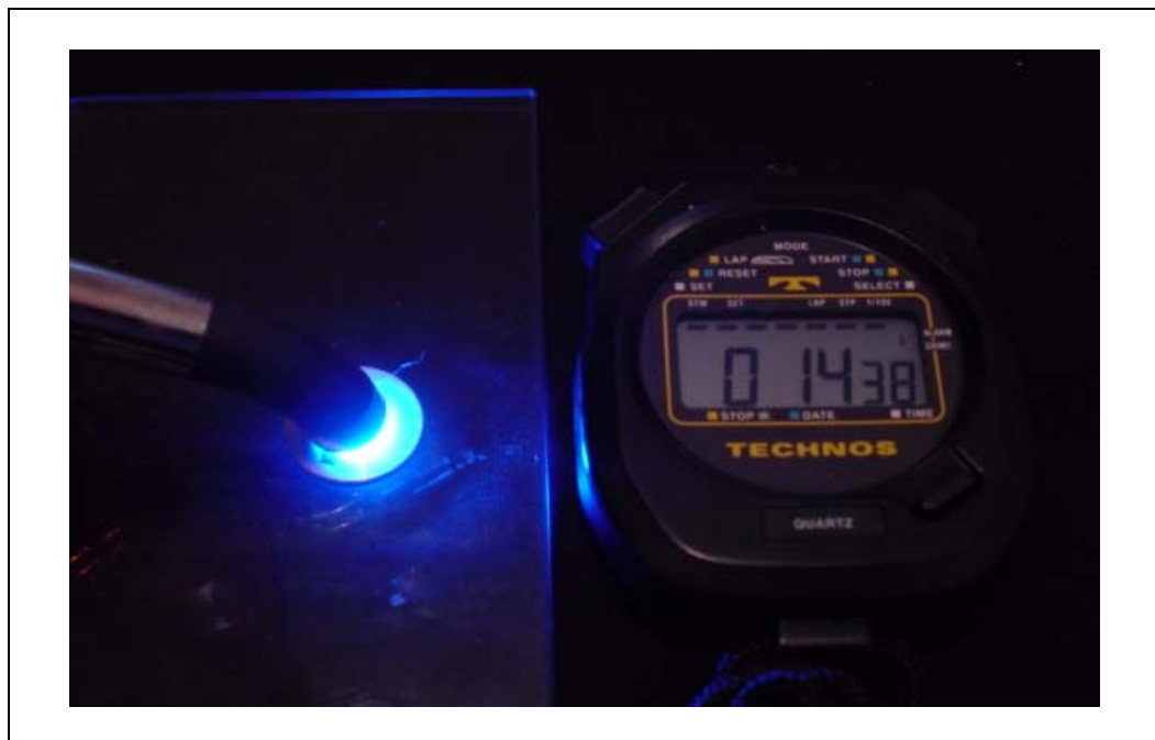
Figura 13 - Processo de fotopolimerização controlado por um cronômetro digital
