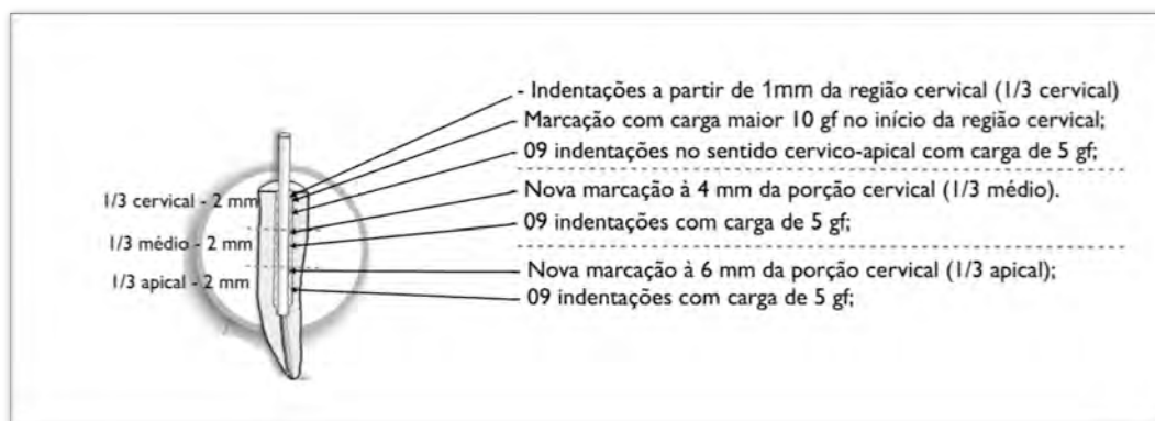
Figura 18 - Desenho esquemático das indentações realizadas na amostra.
