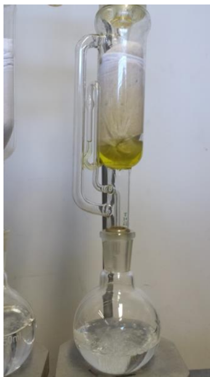
FIGURA 3 – Conjunto extrator Soxhlet®, com amostra de soja triturada
