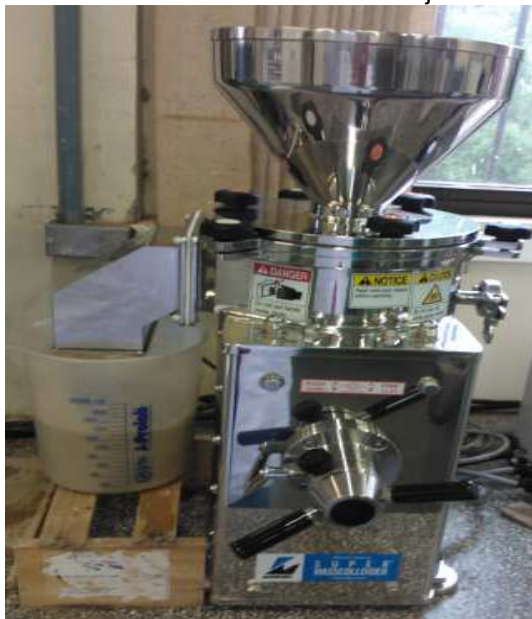
Figura 4.2 : Obtenção da Celulose Microfibrilada da casca de soja em microprocessador
