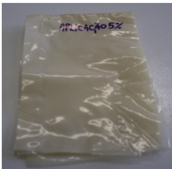
FIGURA 114 - Filme de PEBD obtido a partir da aplicação à 5% do concentrado de cor com 0,24% do pigmento preparado com pasta eletrolítica de pilhas (com 50% em massa de \text{MnO}_2 ) – entre outros componentes.
