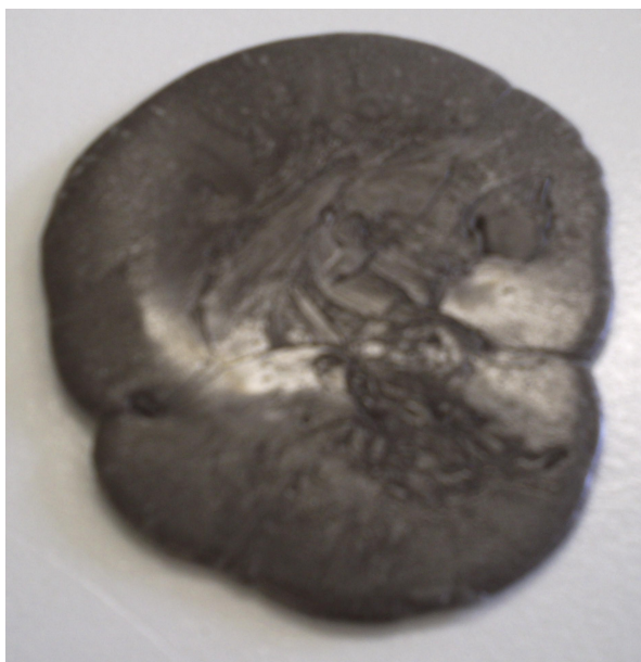
FIGURA 110 - Resultado da aplicação à 2% do pigmento preparado com pasta eletrolítica de pilhas (A50) em PEBD– Teste “Pleno”
