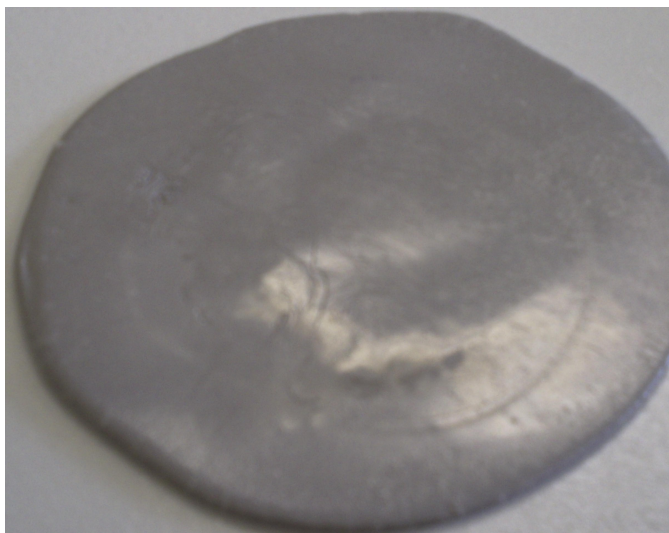
FIGURA 111 - Resultado da aplicação à 2% do pigmento preparado com pasta eletrolítica de pilhas (A50) com 2% de \text{TiO}_2 em PEBD – Teste “de corte”
