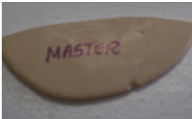
FIGURA 112 - Concentrado de cor de PEBD com 0,24% do pigmento preparado com pasta eletrolítica de pilhas (com 50% em massa de \text{MnO}_2 ) – entre outros componentes.
