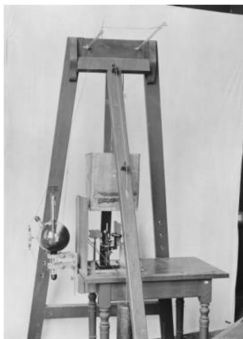
Figura 6. Aparato experimental usado no experimento de interferência em cristais realizado por Max von Laue, Walter Friedrich e Paul Knipping em abril de 1912. Fonte: Eckert (2012).
