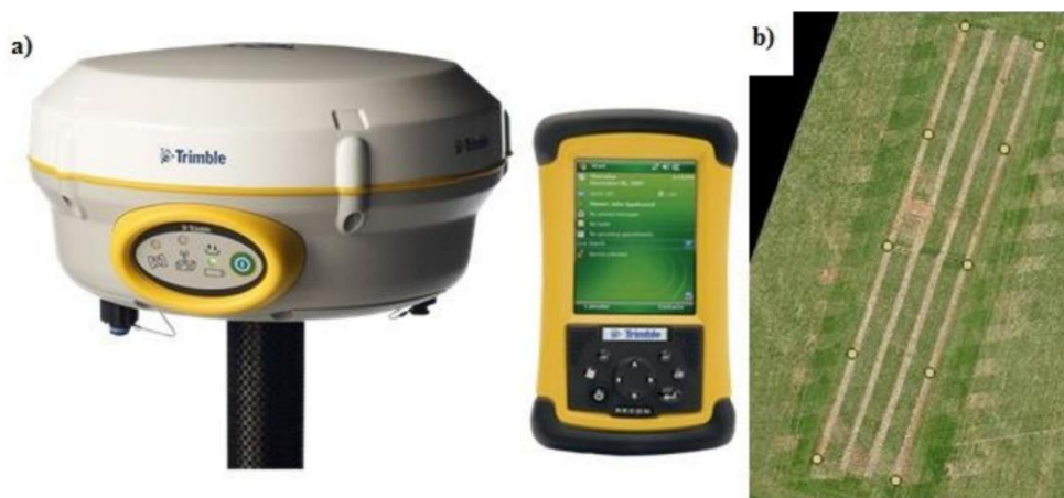
Figura 11– GPS Trimble R4. (a) Disposição dos GCPs na área do estudo de georreferenciamento (b) Fonte: do autor
