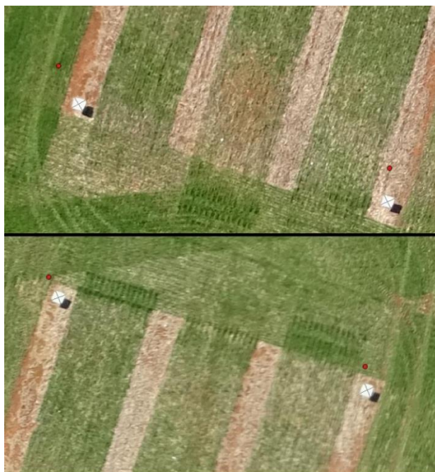
Figura 12 - Demonstração do erro de georreferenciamento (tratamento PIX0) Fonte: do autor
