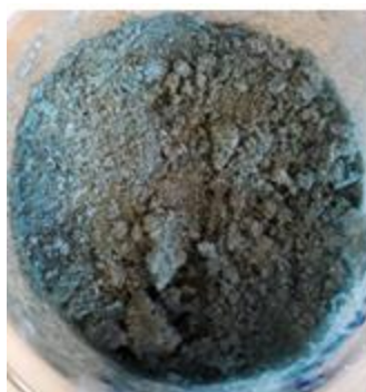
Figura 6: Aspecto da composição após 24 horas na estufa e levemente maceradas com pistilo dentro do Becker.
