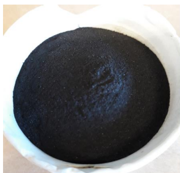
Figura 7: Aspecto da composição após calcinação à 900°C por 4 horas.
