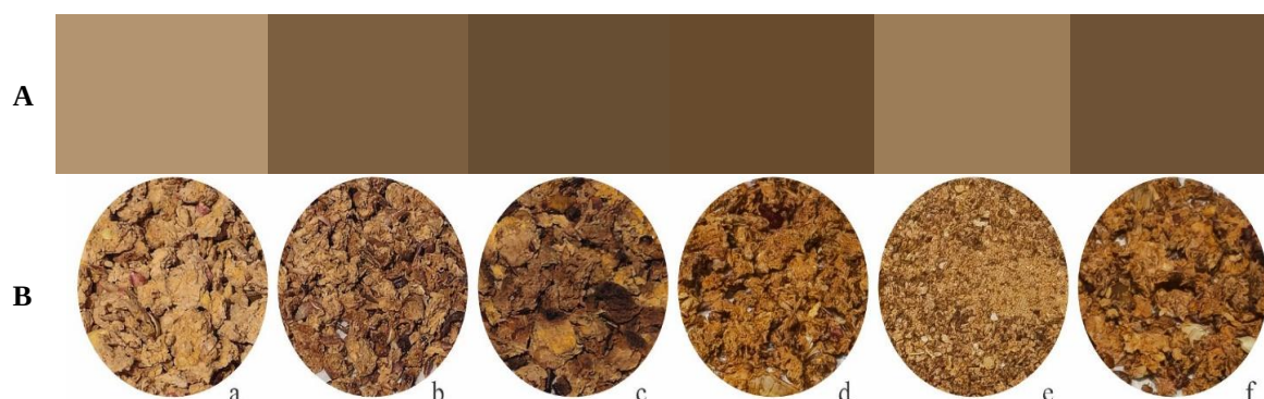
Figura 2.4 - Representação das cores das amostras a partir nas coordenadas colorimétricas obtidas por espectrofotometria (A) e imagens dos bagaços secos (B) em diferentes técnicas de secagem
