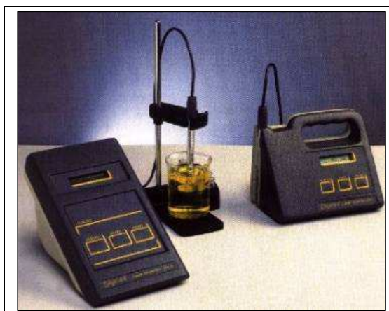
Figura 4 – Fotografia do aparelho de medida de condutividade (esquerda) e de pH (direita).
