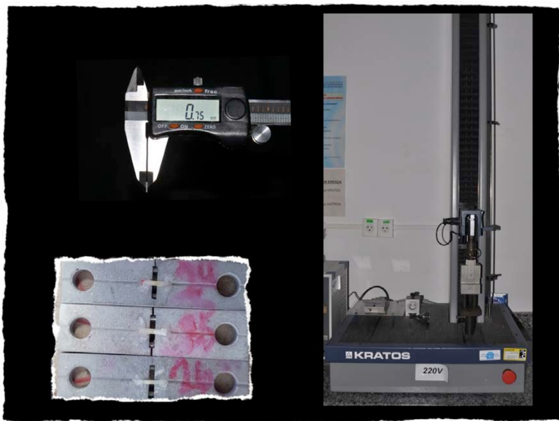
Figura 10. Preparação dos espécimes para máquina de ensaios universal. Mensuração e colagem dos “palitos” no “jig” para serem levados à máquina de ensaios universal Kratos®.
