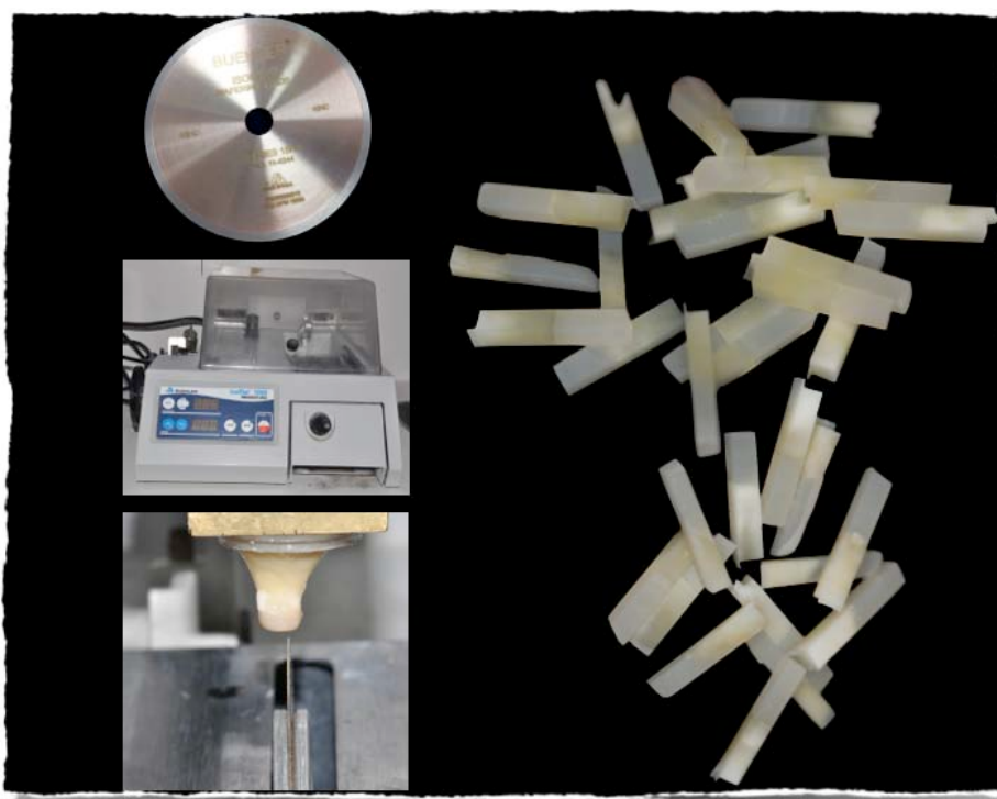
Figura 9. Obtenção dos espécimes em formato de “palito”: Disco de corte de diamante e máquina de corte Isomet 1000 com dispositivo e espécimes em formato de “palito”.
