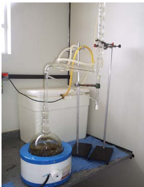
Figura 11 - Aparelho analítico utilizado para obtenção de óleos essenciais por hidrodestilação
