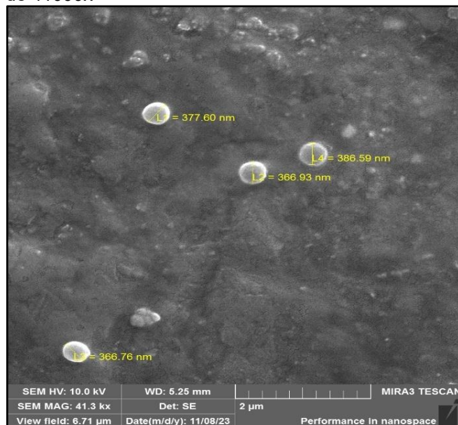
FIGURA 51 – Fotomicrografia das partículas, em tamanho nanométrico, presentes na emulsão pickering , em aumento de 41000x
