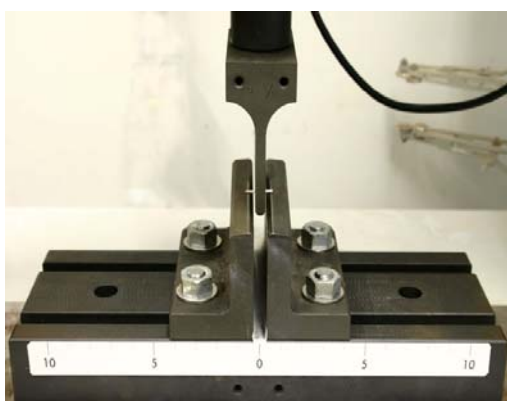
Figura 20 – Corpo-de-prova posicionado Ensaio de Resistência Flexural
