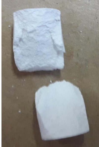
Figura 59 – Superfície de fratura das amostras com amido como fase de sacrifício.
