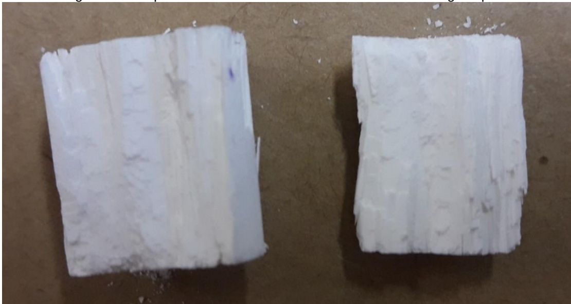
Figura 43 – Superfície de fratura das amostras de freeze casting simples.
