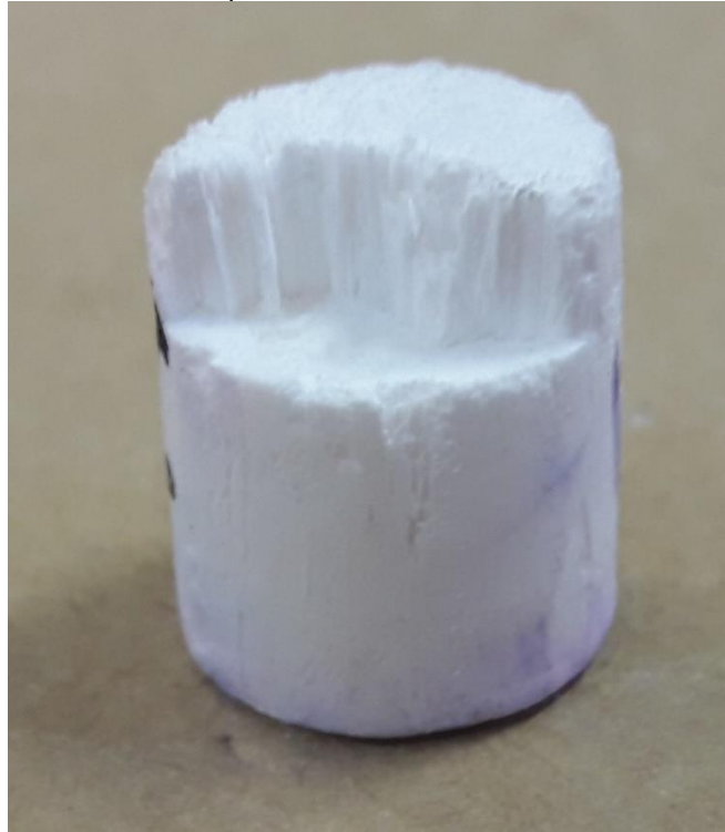
Figura 46 – Superfície de fratura da amostra de freeze casting graduado onde ocorreu falha da camada A25 durante ensaio de compressão.
