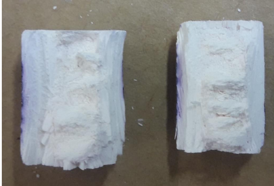
Figura 51 – Superfície de fratura das amostras de freeze casting simples com núcleo SC.
