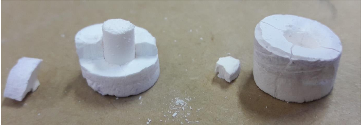
Figura 54 – Superfície de fratura das amostras de freeze casting graduado com núcleo GC.
