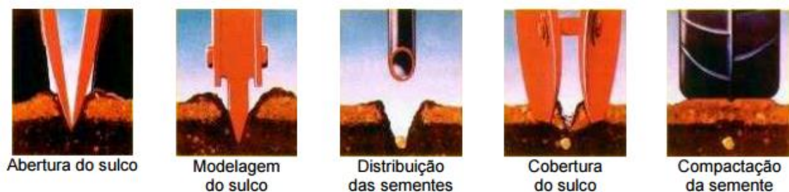
Figura 4 – Principais funções desempenhadas por uma plantadeira
