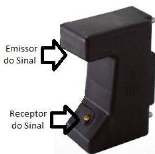
Figura 8 – Ilustração de um sensor fotoelétrico de infravermelho por barreira
