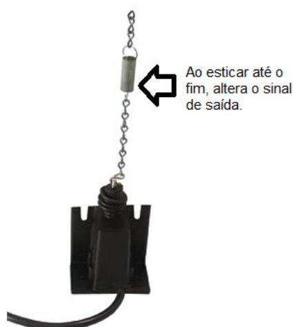
Figura 22 – Ilustração de um sensor de levante do implemento
