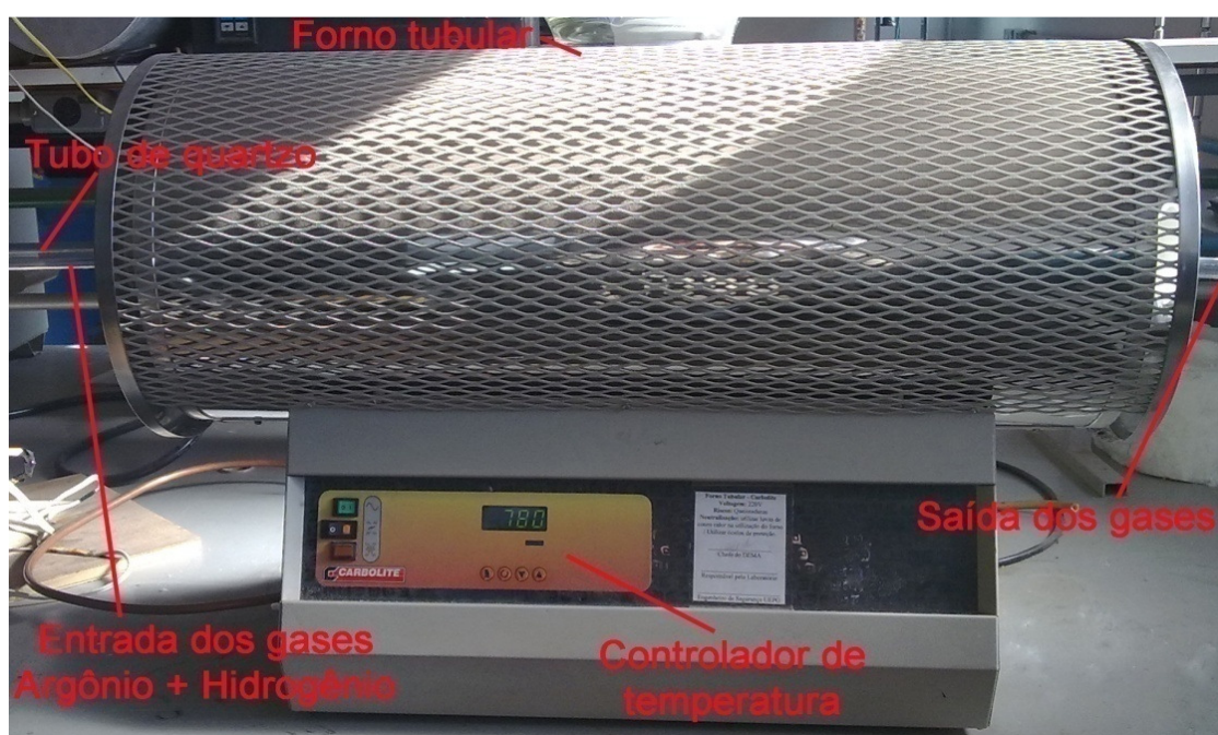
Figura 3.6 – Forno para tratamento térmico com atmosfera controlada por argônio e hidrogênio do DEMA/UEPG. Fotografias por A. E. Yonekubo.
