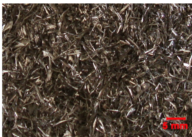
Figura 4.3 – Cavacos feitos a partir da chapa de aço inoxidável superdúplex UNS S32520 laminada. Fotografia por A. E. Yonekubo.
