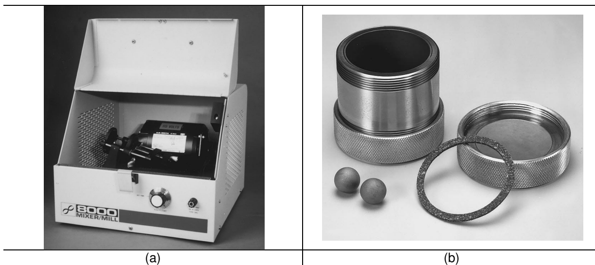
Figura 2.11 – (a) Moinho Spex 8000. (b) Conjunto do jarro de carbeto de tungstênio consistindo de frasco, tampa, gaxeta, e bolas.
