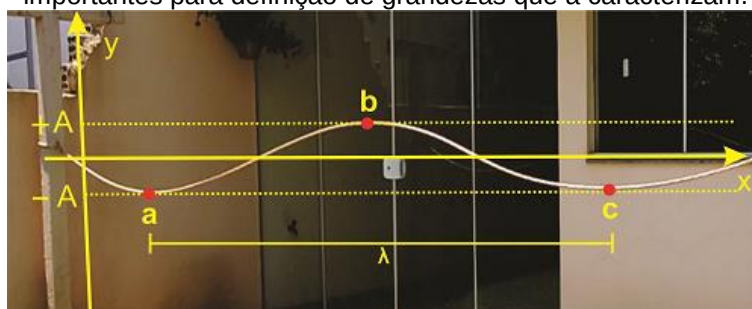
Figura 3.17 – A representação de um instantâneo de uma onda em uma corda e pontos importantes para definição de grandezas que a caracterizam.
