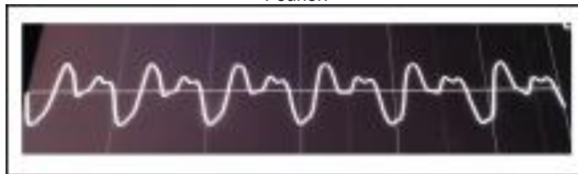
Figura 3.25 – Uma onda periódica produzida por um teclado musical a partir de uma série de Fourier.
