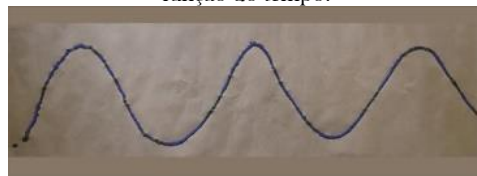
Figura 4 - Marcação do deslocamento do pêndulo em função do tempo.
