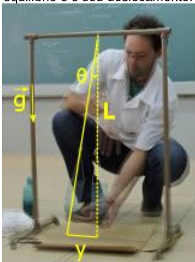
Figura 3.4 – Superposição de duas imagens para observar o ângulo formado entre o ponto de equilíbrio e o seu deslocamento.
