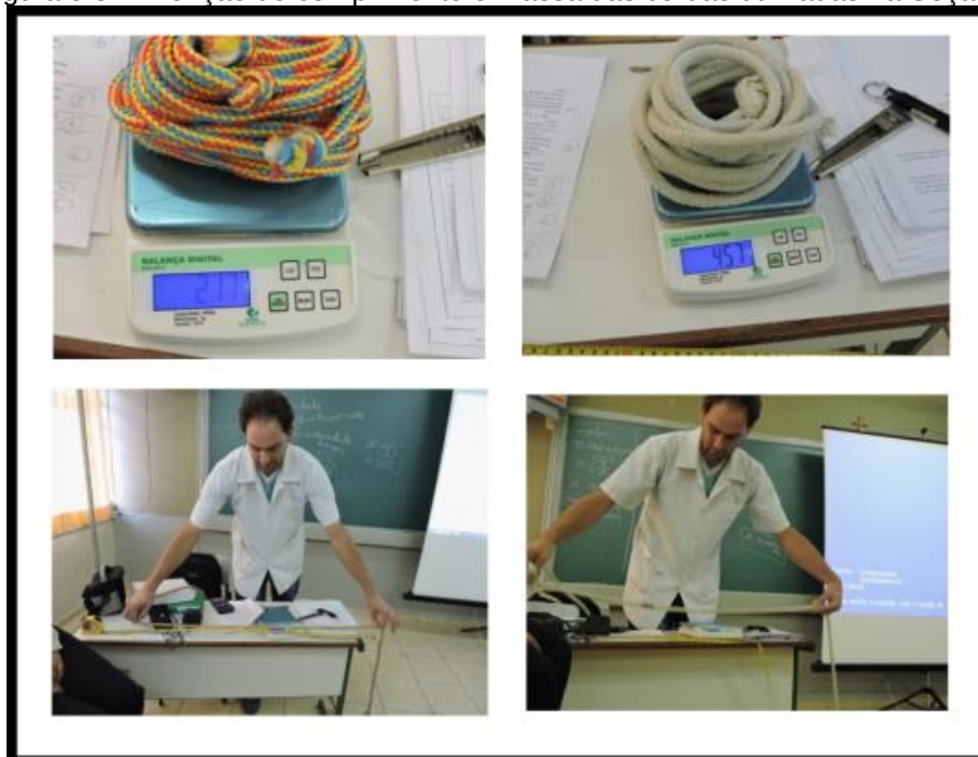
Figura 5.8 – Aferição do comprimento e massa das cordas utilizadas na Seção 4.
