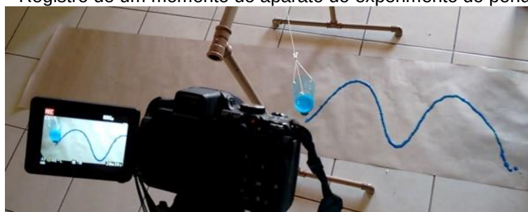
Figura 5.7 – Registro de um momento do aparato do experimento do pêndulo em uso.
