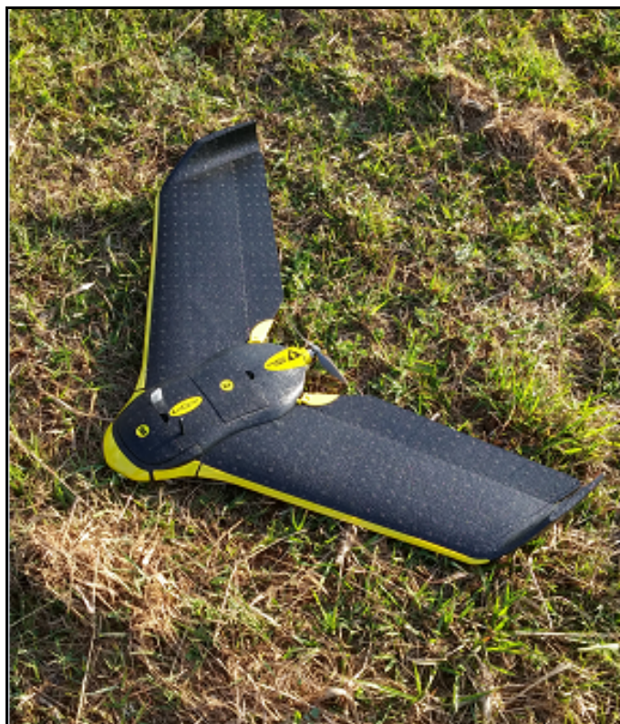
Figura 12. RPA eBee utilizada nas coletas de dados
