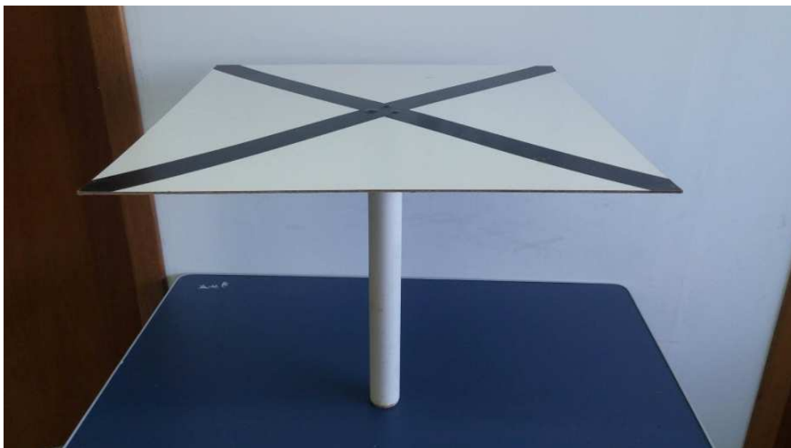
Figura 19. Marcadores utilizados como GCPs para a correção de georreferenciamento
