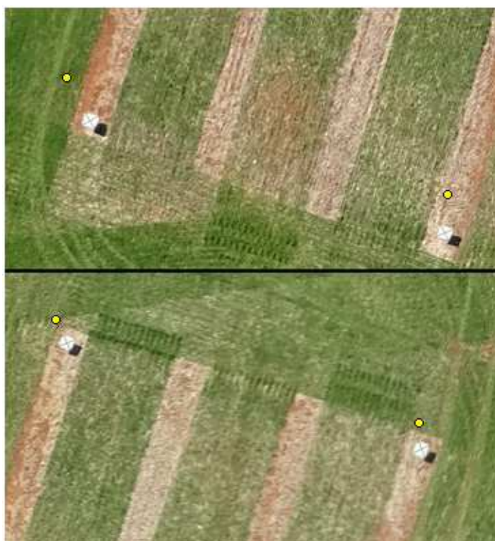
Figura 29. Demonstração do erro de georreferenciamento (tratamento Pix0)
