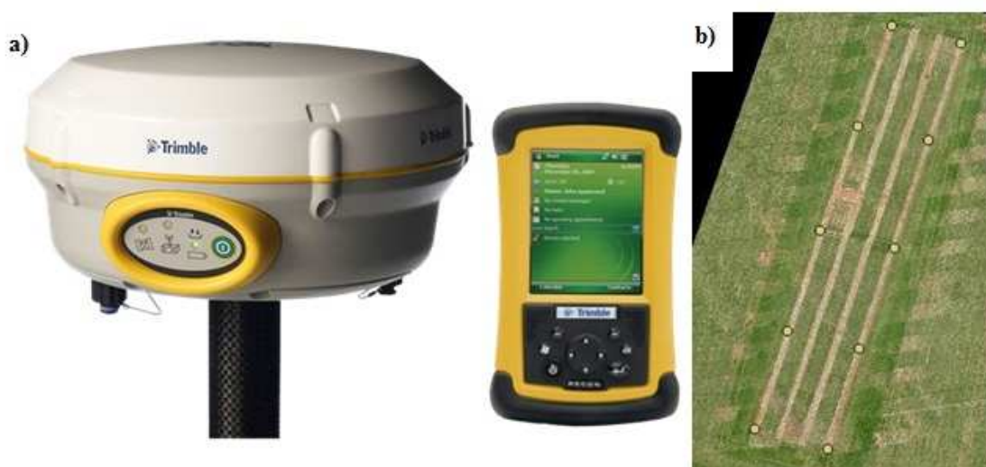
Figura 20. (a) GPS Trimble R4 e (b) a disposição dos GCPs na área experimental
