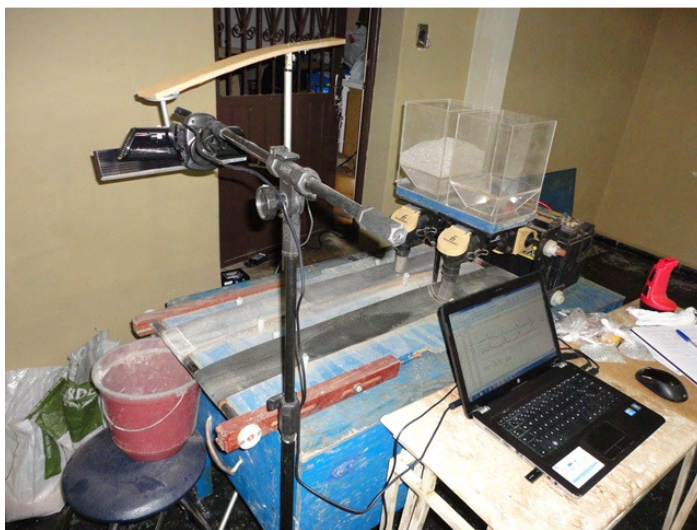
Figura 36 - Esteira para simulação de aplicação de fertilizantes
