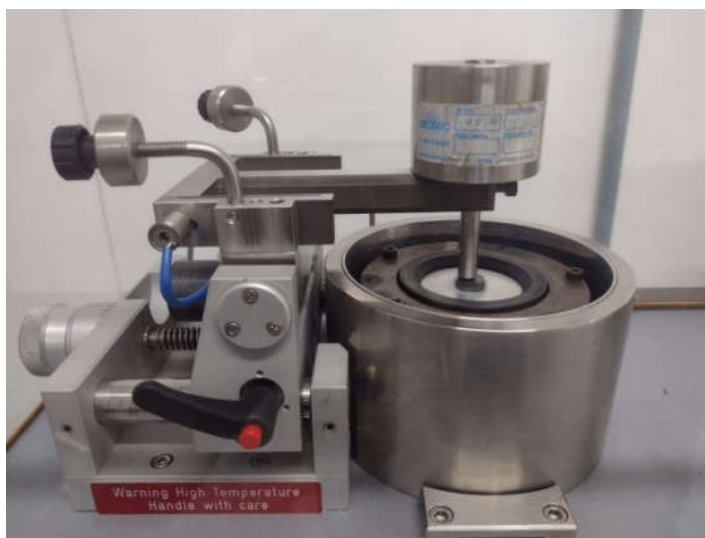
Figura 16 – Tribômetro com configuração esfera-sobre-disco.
