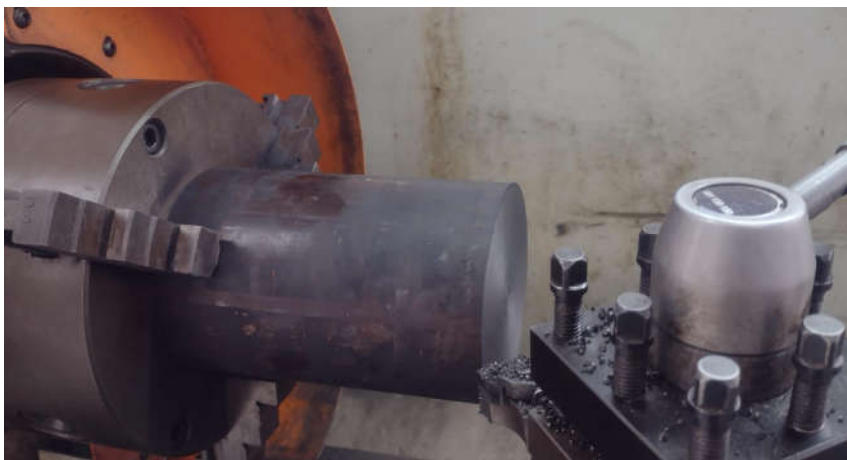
Figura 22 – Preparação dos corpos de prova de ferro fundido.
