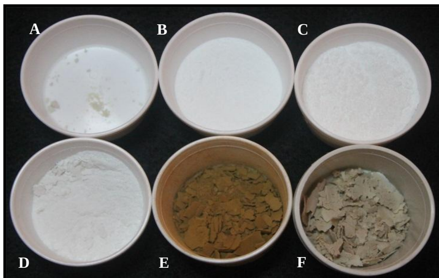
Figura 6: Cinzas residuais após incineração dos dentifrícios. A- Controle negativo sem abrasivo; B- Controle negativo com abrasivo; C – Experimental WCS; D- Experimental HS; E- Colgate® Pró-Alívio™; F- Sensodyne® Rápido Alívio™.
