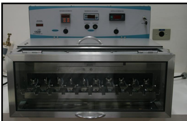
Figura 18: Equipamento de escovação simulada.
