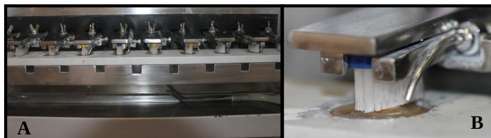
Figura 19: A- Suporte metálico com as 10 amostras para escovação simulada. B- Detalhes da amostra posicionada e cerdas da escova dental macia cobrindo a amostra completamente.
