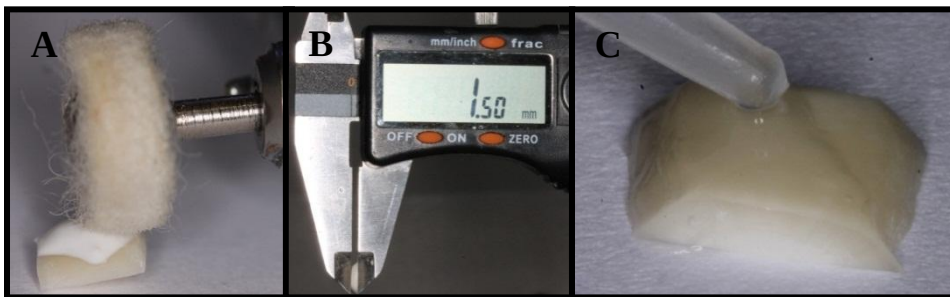
Figura 12: A- Polimento com óxido de alumínio e disco de feltro; B- Espessura final das amostras confirmadas com paquímetro digital; C- Aplicação de EDTA a 24% para remoção de smear layer.
