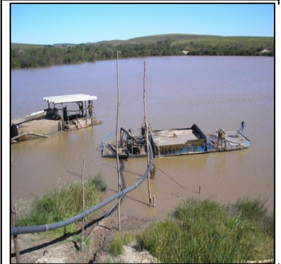
Figura 9: Balsa-draga (batelão) em conexão para descarga (cava 06). Autor: Melo, 2008.
