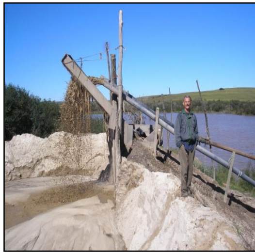
Figura 8: Descarga da areia em cancha, para a separação de impurezas (cava 01). Autor: Melo, 2008.
