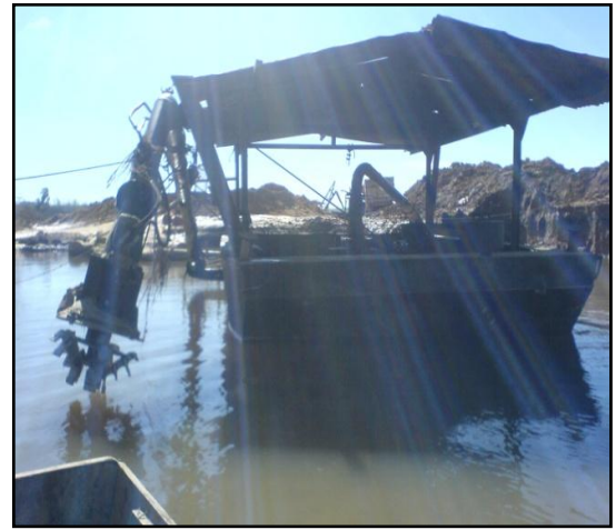
Figura 7: Dragagem com triturador conectado às tubulações para extração de areia. Autor: Melo, 2009.
