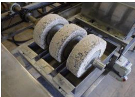
Figura 6 - Exemplo de degradação de discos de concreto pelo método TAP.
