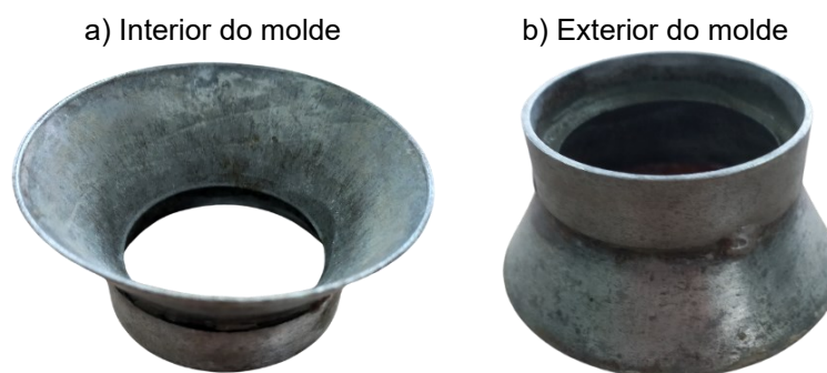
Figura 15 - Molde de tronco de cone utilizado para determinação do espalhamento no ensaio com pastas
