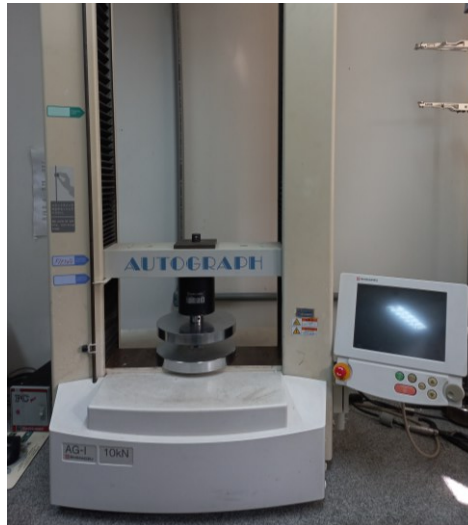
Figura 18 - Máquina de teste universal utilizada para obter a resistência à compressão e à tração das pastas.
