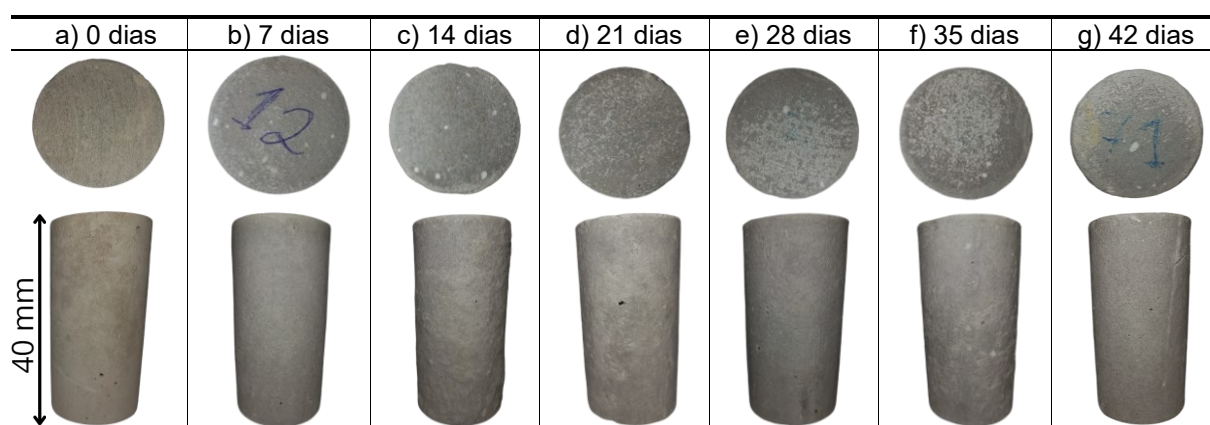
Figura 25 - Evolução visual das pastas de cimento e diabásio no ácido sulfúrico.
