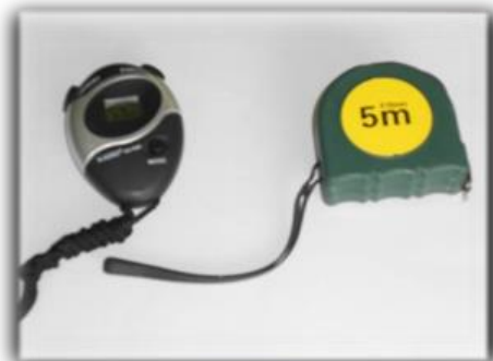
Figura 9 - Foto do kit experimental para determinação da Velocidade.
