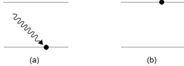
Figura 2 – Sistema com a frequência de anti-ressonância AJC. Em (a) temos o sistema de dois níveis, o qual se encontra no estado excitado e um fóton é emitido. Em (b) representamos o estado fundamental sem a presença do fóton.
