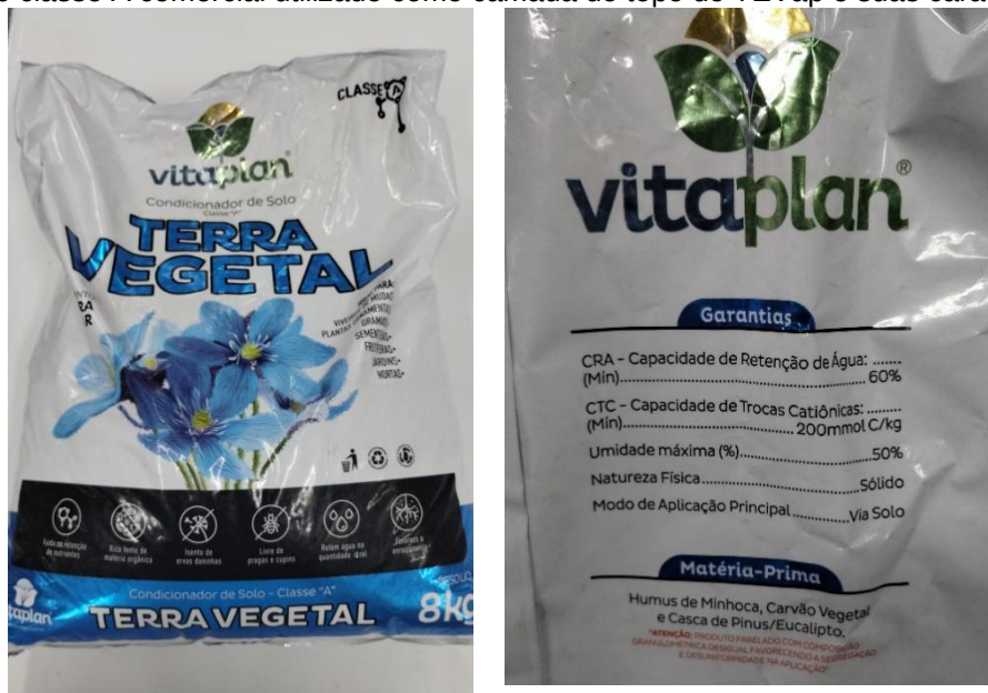
Figura 7 - Solo classe A comercial utilizado como camada do topo do TEVap e suas características
