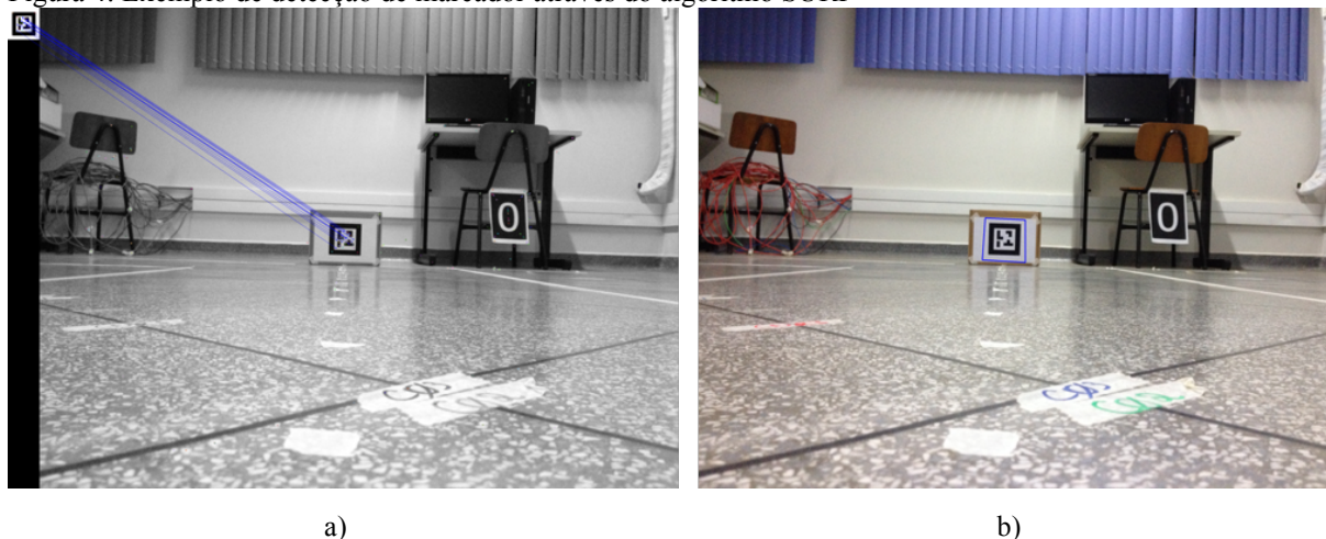
Figura 4: Exemplo de detecção de marcador através do algoritmo SURF
