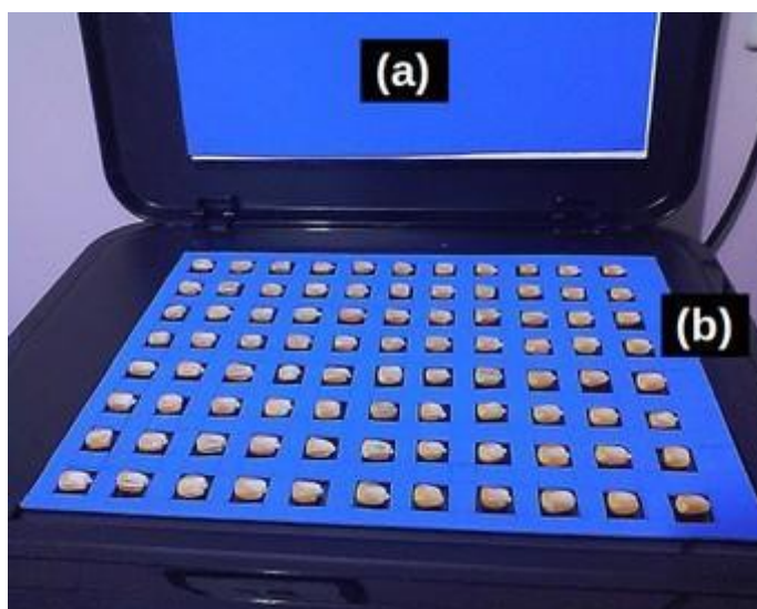
Figura 15 – Scanner SAMSUNG usado para aquisição de imagens: (a) fundo em EVA; (b) matriz em EVA para posicionamento das sementes.
