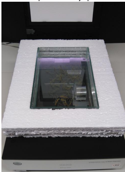
Figura 24. Escâner com as molduras de isopor e bandeja posicionada contendo amostra de uma raiz.
