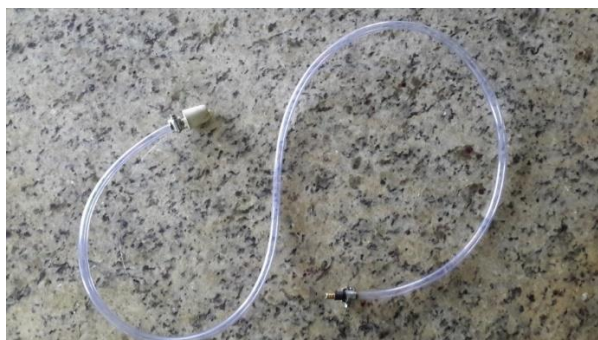
Figura 22 – Aspecto final do cano de silicone com os terminais acoplados. Fonte: O autor.
