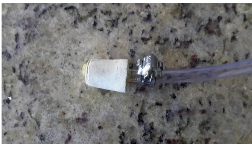
Figura 19 - Ponteira finalizado e presa com a abraçadeira ao tubo de silicone. Fonte: O autor.
