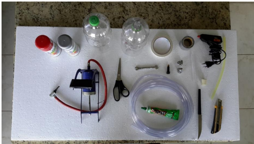
Figura 06 – Materiais utilizados para construir o foguete movido a água e ar comprimido. Fonte: O autor.
