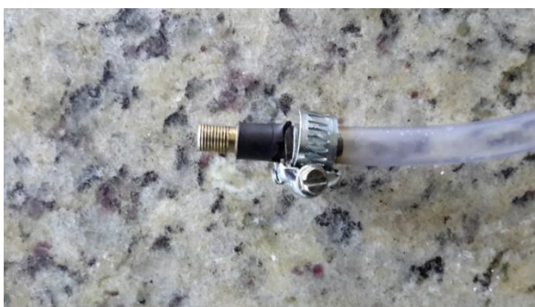
Figura 21 - Bico preso à mangueira de silicone. Fonte: O autor.
