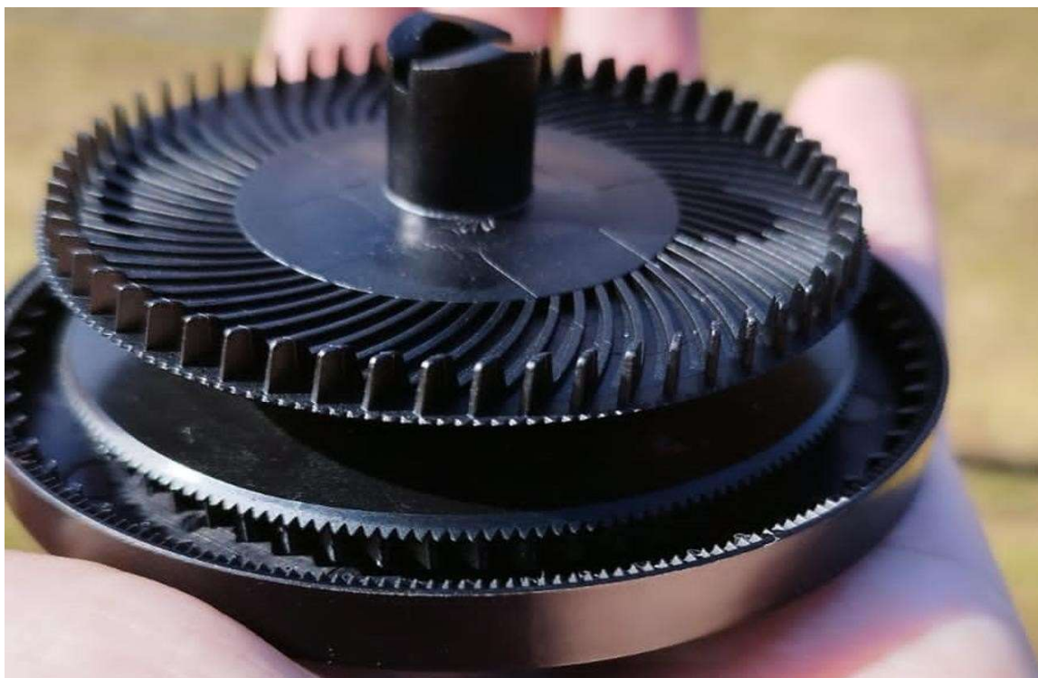
Figura 3 – Bico rotativo LX8060 SZ TM com sistema duplo de pulverização atomizado
