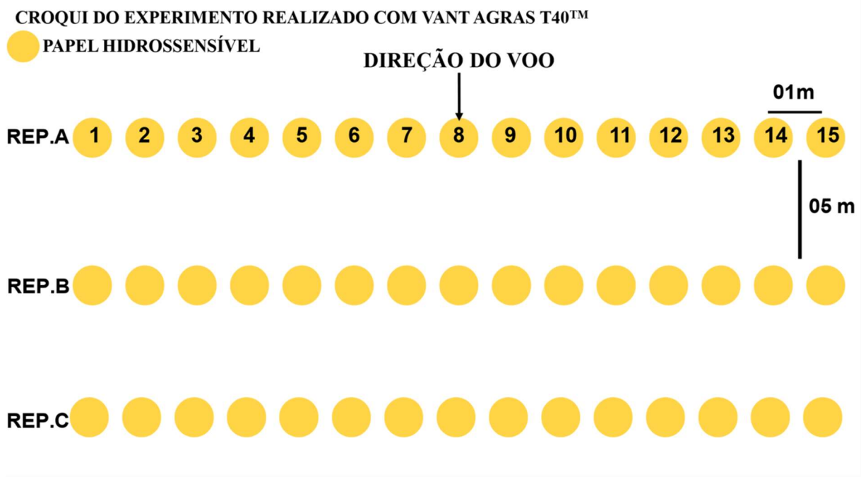
Figura 1 - Croqui representativo do experimento conduzido com o VANT DJI™ AGRAS T40 para avaliação da faixa de deposição, com três repetições (REP. A, REP. B e REP. C), cada uma contendo 15 papéis hidrossensíveis dispostos linearmente com espaçamento de 1,0 m entre eles, com deslocamento do VANT de forma transversal e centralizada, setembro de 2023 e 2024, Ponta Grossa – PR.
