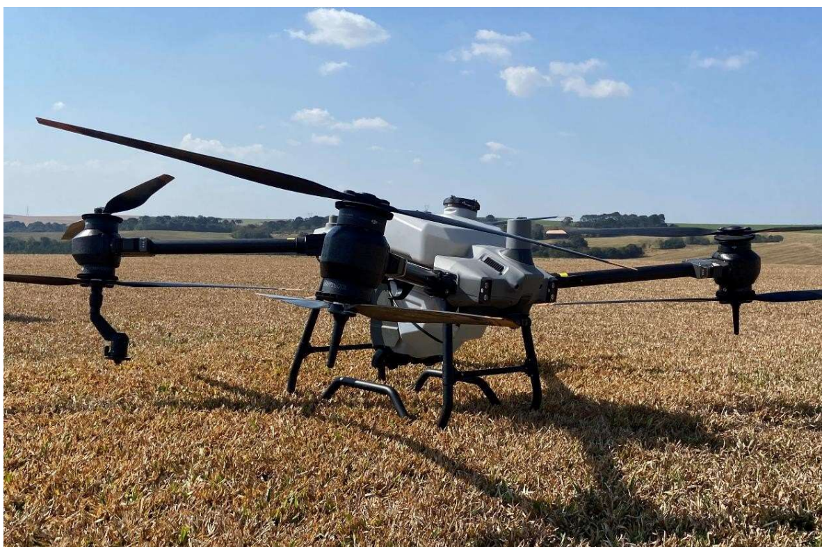
Figura 2 – Veículo aéreo não tripulado (VANT) DJI AGRAS T40™, com capacidade de tanque de 40 litros, 08 rotores, munido da 02 pontas de pulverização rotativas LX8060 SZ™, utilizado no experimento sobre faixa de pulverização com diferentes tamanhos de gotas, setembro de 2023 e agosto 2024, Ponta Grossa – PR.
