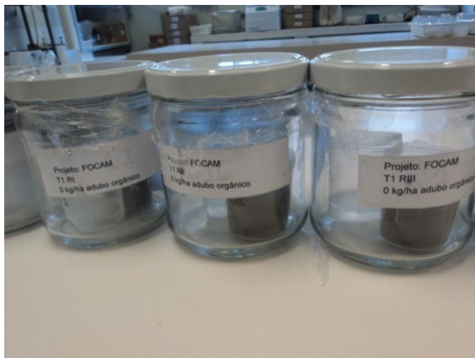
Figura 5. Frascos utilizados na incubação, juntamente com as amostras de solo com e sem ROA e seus respectivos frascos de NaOH.
