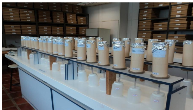
Figura 15. Disposição do experimento para avaliação da percolação de nitratos. Tubos de PVC contendo amostras de solo indeformadas e peneirado com adição ou não de ROA em experimento de análise de percolação de \text{NO}_3^- .
