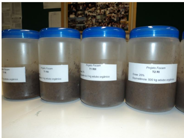
Figura 16. Frascos de polipropileno contendo solo peneirado com adição ou não de resíduo de abatedouro utilizado no experimento para avaliação da nitrificação.
