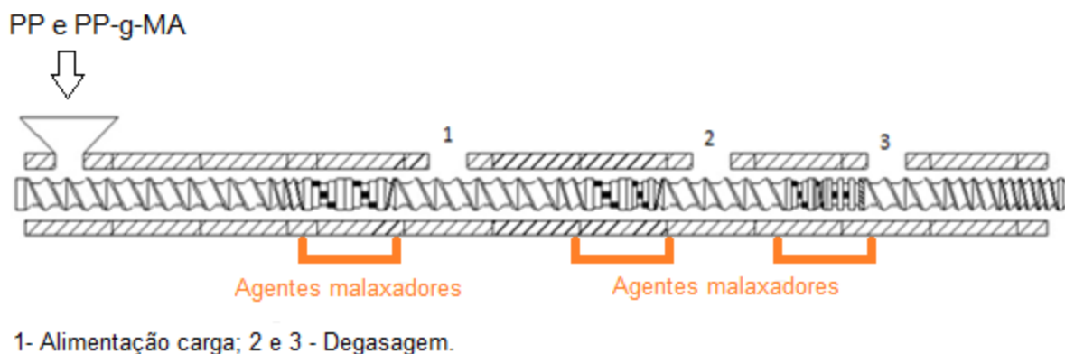
FIGURA 18 - Perfil de rosca utilizado no processamento das amostras.
