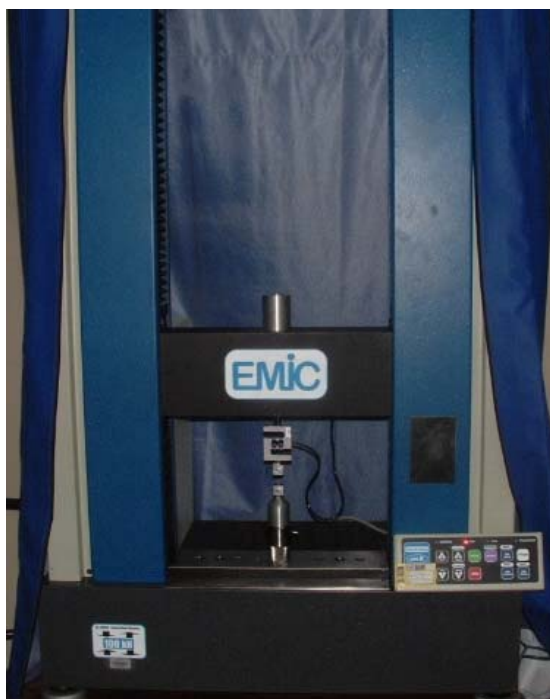
Figura 22 - Máquina de ensaio universal DL 10000 (EMIC®)
