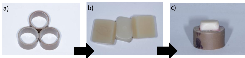
Figura 2. a) Matrizes de PVC. b) Blocos de compósitos CAD/CAM cortados em dimensões iguais. c) Bloco de compósito CAD/CAM embutido.
