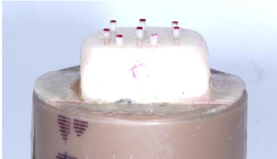
Figura 4. Amostras de cimentos após remoção dos tygons.
