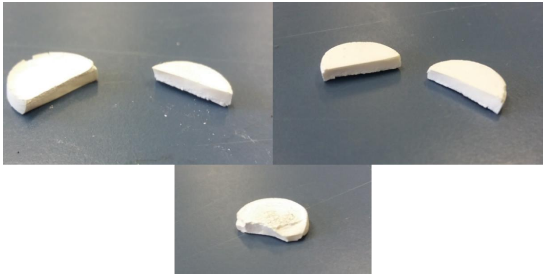
Figura 69. Superfícies de fratura das amostras com amido de arroz como fase de sacrifício.
