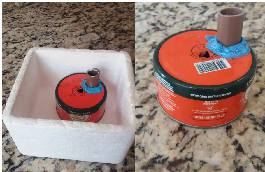
Figura 12. Sistema para processamento de amostras por freezecasting .
