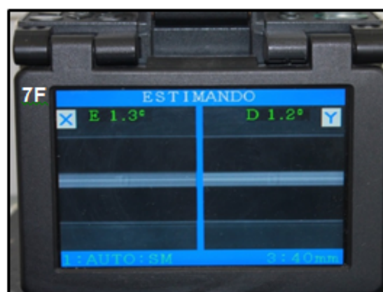
Figura 7 – Processo de emenda de uma fibra ótica com um pigtail: A - Remoção do polímero; B - clivagem da fibra ótica; C e D - Emenda de fibras óticas; E e F - ARC Splicer
