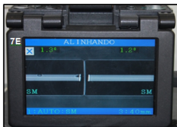
Figura 7 – Processo de emenda de uma fibra ótica com um pigtail: A - Remoção do polímero; B - clivagem da fibra ótica; C e D - Emenda de fibras óticas; E e F - ARC Splicer
