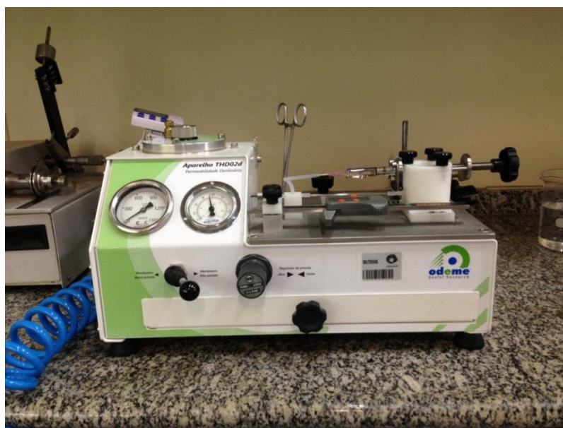
Figura 3: Aparelho de permeabilidade dentinária e pressão intrapulpar modelo THD-02d.
