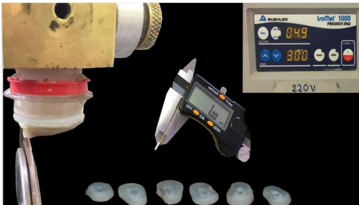
Figura 16 – Obtenção das fatias de 1mm de espessura na máquina de corte.
