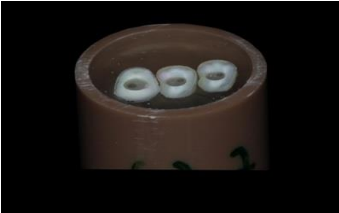
Figura 21 – Fatias embutidas em resina acrílica com a face de teste virada para cima.
