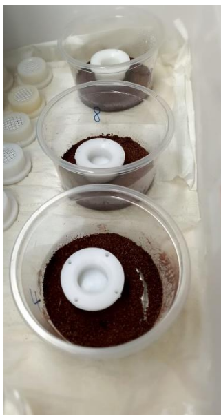
Figura 19 - Dispositivo DGT adicionados em amostra de solo com 100% da capacidade de retenção de água.
