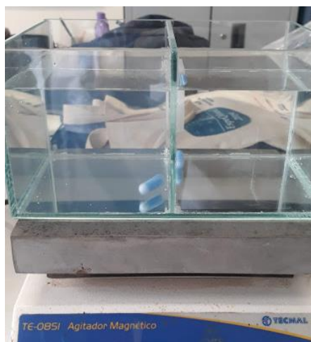
Figura 11 - Câmara de difusão com dois compartimentos, separado por uma placa de vidro e com orifício de 3,14 cm onde está presente um dispositivo DGT utilizado para adicionar o hidrogel difusivo.
