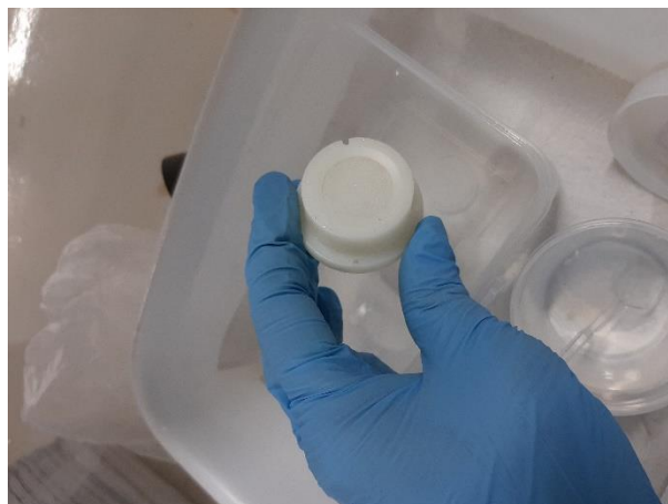
Figura 14 - Dispositivo DGT preparado no laboratório.
