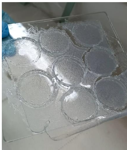
Figura 12 - Discos de hidrogel com a chelex-100 imobilizada em agarose seccionados.
