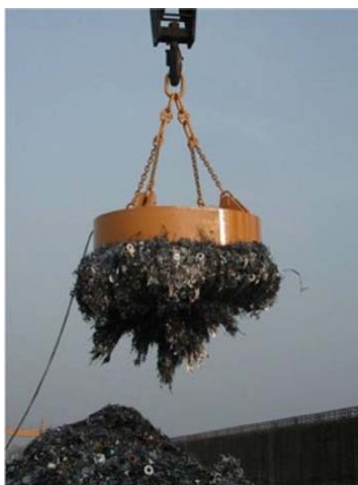
Figura 1 13 – Eletroímã em utilização em ferro velho.
