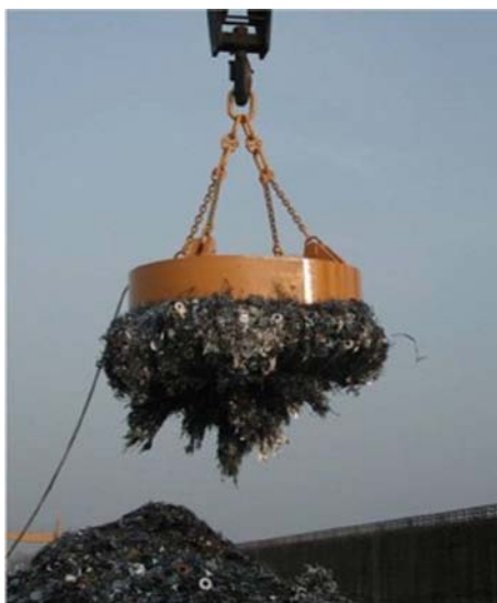
Figura 1 3 – Eletroímã em utilização em ferro velho.
