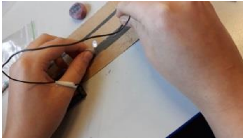
Figura 34: Alunos testando o circuito de tinta condutiva, verificando a variação de resistência através da variação de luminosidade do LED.
