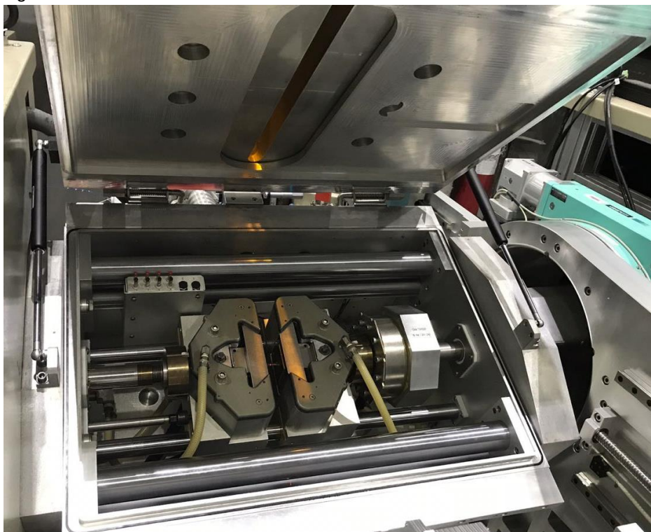
Figura 4.2 – Câmara do simulador termomecânico da Gleeble 3S50®.
