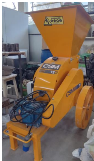
Figura 9 – Britador móvel elétrico de mandíbula CSM TE 2 no Laboratório de Materiais de Construção da UEPG
