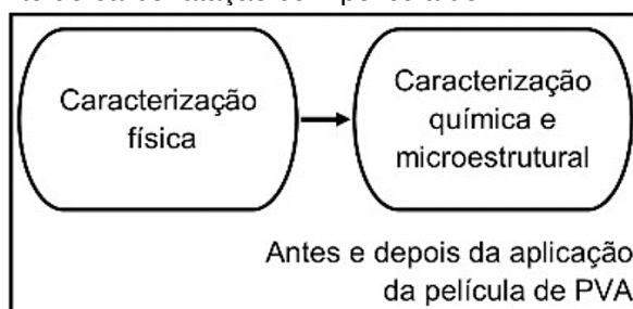
Figura 12 – Fluxograma do processo de caracterização do agregado reciclado de concreto em estudo, antes e depois do tratamento de carbonatação com película de PVA
