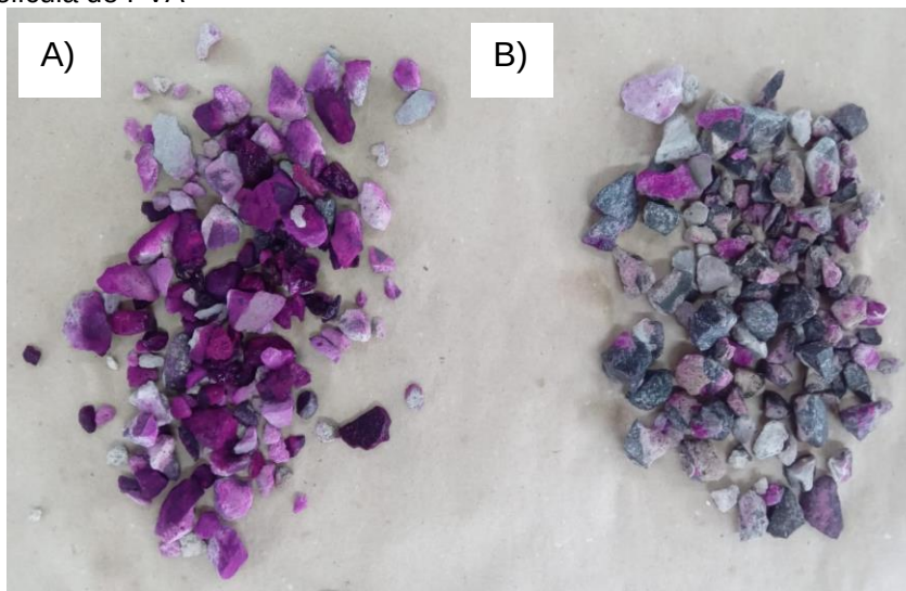
Figura 11 – Indicação de pH por aspersão de solução de fenolftaleína em agregado reciclado in natura e tratado por película de PVA
