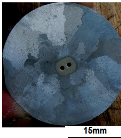
Figura 4.33 – Macrografia da corrida 12 – Corrida preliminar com alumínio comercialmente puro.
