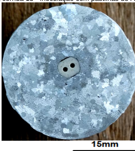
Figura 4.36 – Macrografia da corrida 13 - Inoculação com pastilhas de Al20%TiB 2 sem moagem.
