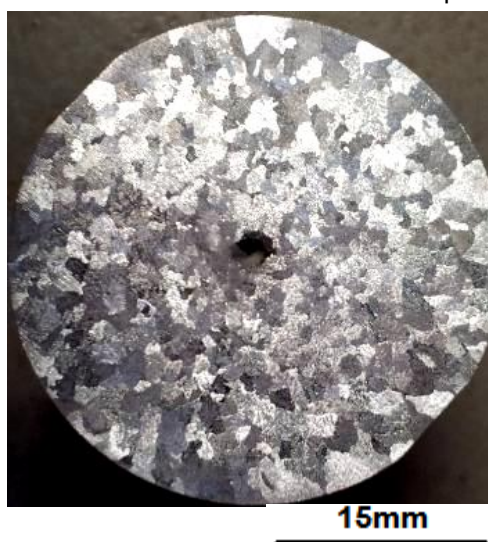
Figura 4.16 - Macrografia da corrida 04 – alumínio comercialmente puro + Al10%Ti comercial.
