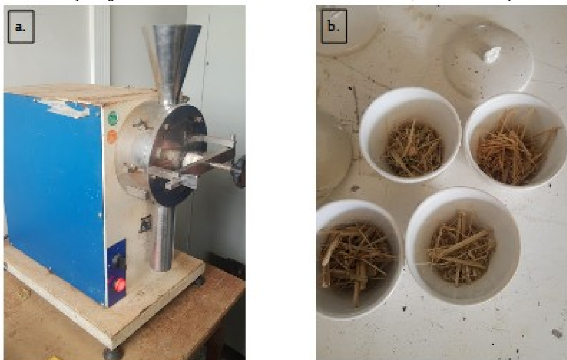
Figura 10 - Na imagem a., moagem de biomassa de bambus em moinho industrial no Laboratório de Mecanização Agrícola na Universidade Estadual de Ponta Grossa; em b. Material já triturado.
