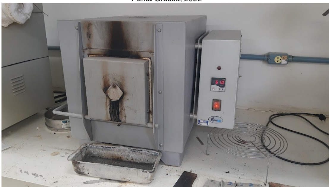
Figura 11 - Forno mufla Zezimaq® para o processo de carbonização do carvão de bambus ( Bambusa vulgaris e Phyllostachys aurea ), laboratório de Tratamento Térmico, do Grupo de Pesquisa em Materiais Estruturais e Funcionais da Universidade Estadual de Ponta Grossa, Ponta Grossa, 2022
