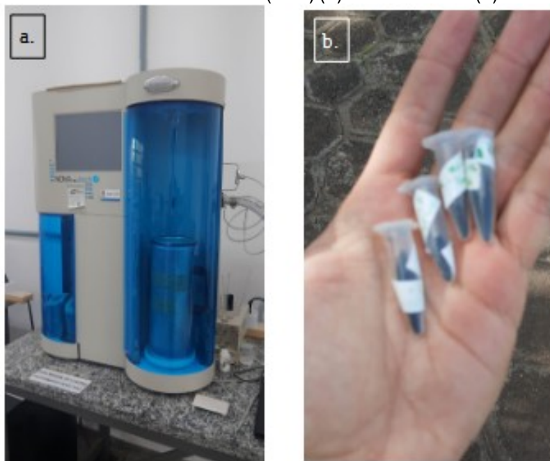
Figura 16: Equipamento para análise de área superficial por Brunauer-Emmett-Teller (BET) (a) e amostras em (b).
