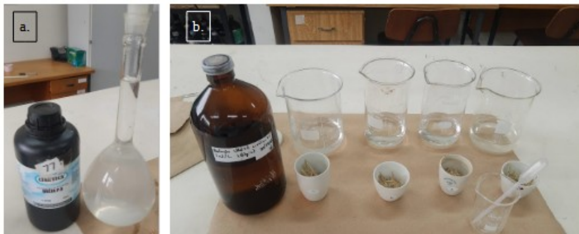
Figura 13: Solução de 1 mol/L de ureia em água destilada na figura a. e 2g de biomassa em 100 mL de solução de ureia na figura b.
