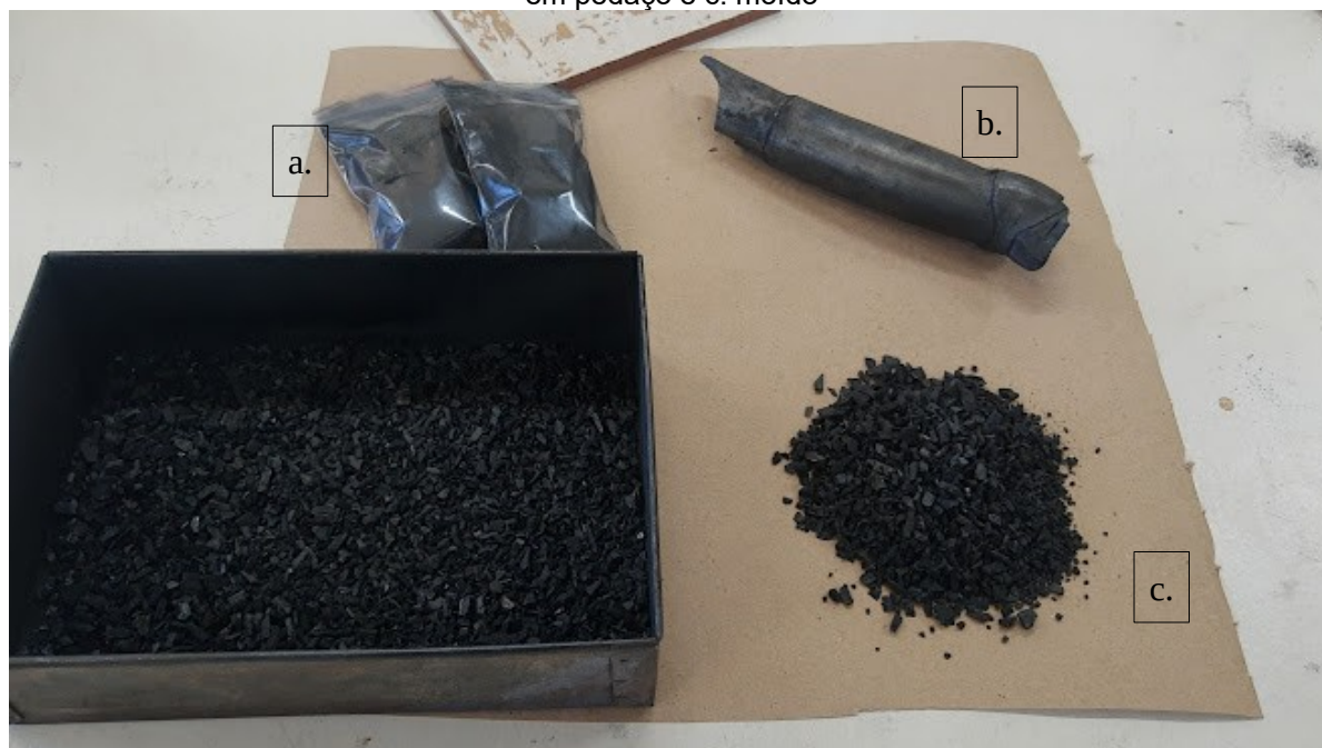
Figura 12 - Carvões de bambu Phyllostachys aurea em diferentes granulometrias: a. pulverizado, b. em pedaço e c. moído
