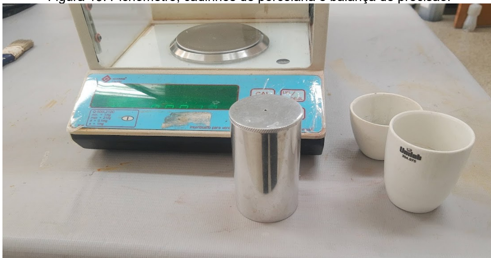
Figura 19: Picnômetro, cadinhos de porcelana e balança de precisão.
